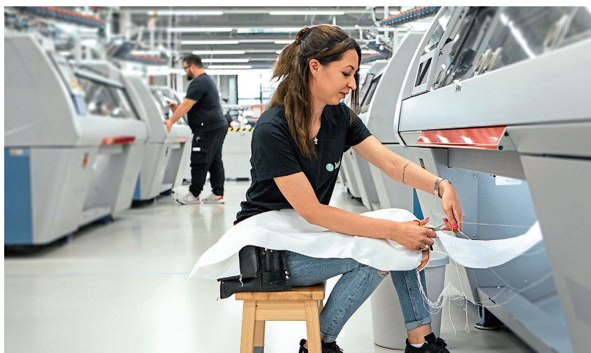
Kompressionsversorgung ist sehr individuell. Hier bedient eine Mitarbeiterin von Juzo eine Flachstrickmaschine.
